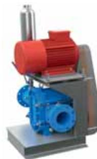
Esecuzione con motore elettrico e trasmissione pulegge / cinghie
