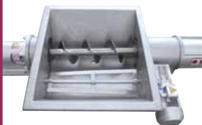
Pompa serie TLS con pale rompiponte per trasferimento di uva intera-vinacce fermentate
