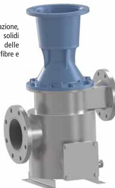
**Bio-Macerator Bellin serie BMF** - esecuzione per applicazioni in impianti di biogas: ampio corpo in acciaio zincato (inox su richiesta), fondo per deposito corpi grossolani e pesanti con apposita apertura per facile ispezione e pulizia.
