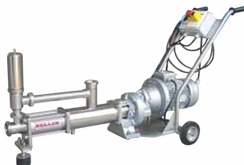
Pompa mono con variatore di velocità e by-pass contro la sovrappressione
