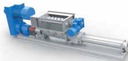
Esecuzione con tramoggia e coclea di alimentazione dotata di dispositivo rompiponte superiore azionato da motoriduttore indipendente.
